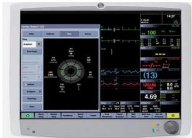
Модуль E-PiCCO обеспечивает непрерывное измерение сердечного выброса (CCO) на основе анализа пульсационных контуров, сердечного выброса методом транспульмональной термодилуции (С.О.) и артериального давления (Р).
